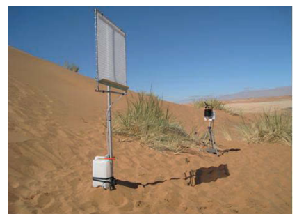
Durch solche Nebelfänger könnte zukünftig auch in Ghana Trinkwasser aus Nebel gewonnen werden
